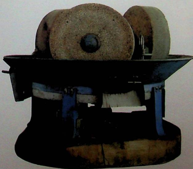
A lato: L'antico "Trapetum"; costituito da una grossa pila di pietra sulla quale girando due o tre macine di pietra-granito cilindriche fissate ad un asse centrale, schiacciano le olive. La pasta di olive che si ricava dallo schiacciamento dei frutti, viene immessa nei "friscoli", (borse porose intessute di fibra vegetale) che sottoposte a pressione, liberano la parte liquida contenuta nella pasta oleosa.
