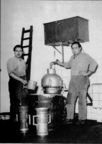
Foto 5. Separatore per l'estrazione dell'olio 1959-60.
